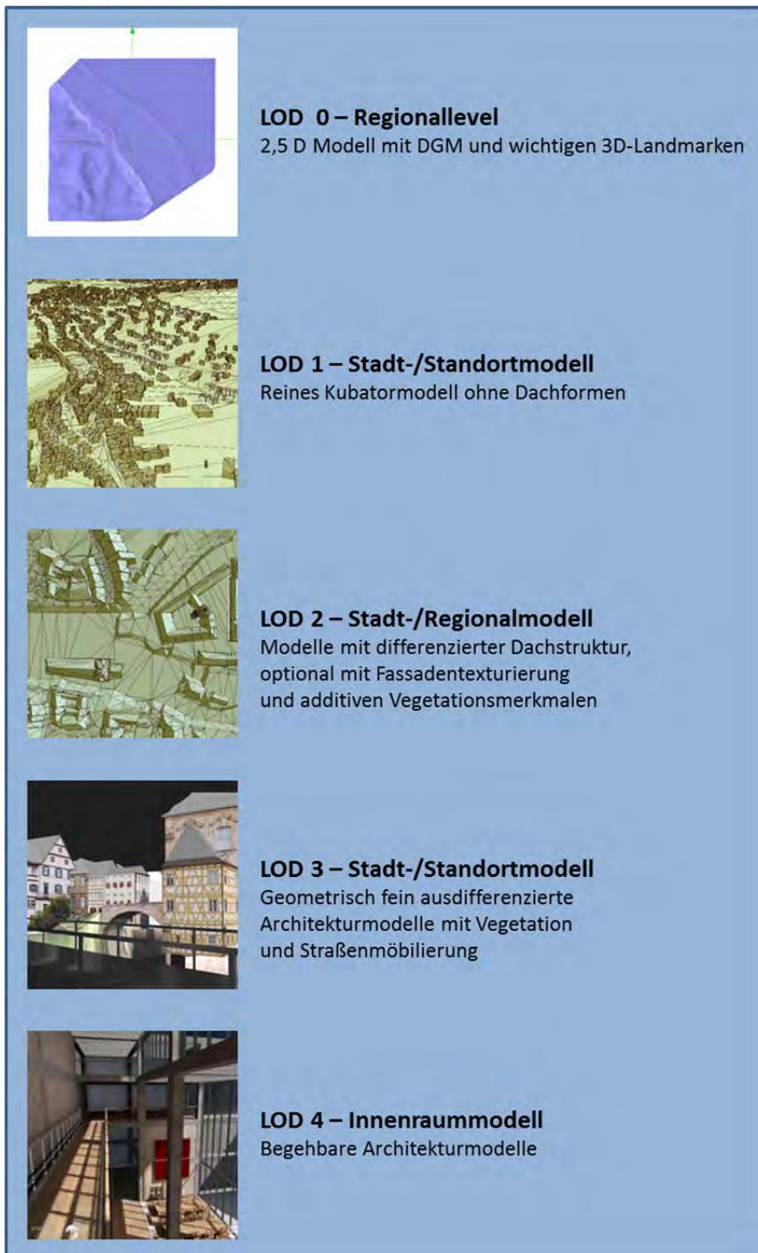
Abbildung 4: Level of Detail – Stufen [Eigene Darstellung unter Verwendung von ZEILE 2003:20]
