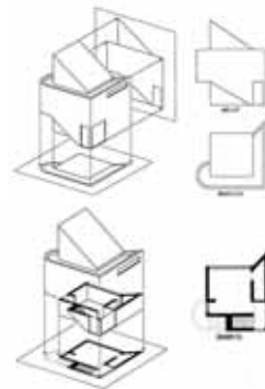
Darstellung einer Draufsicht, Ansicht und Grundriss nach DIN 1356
