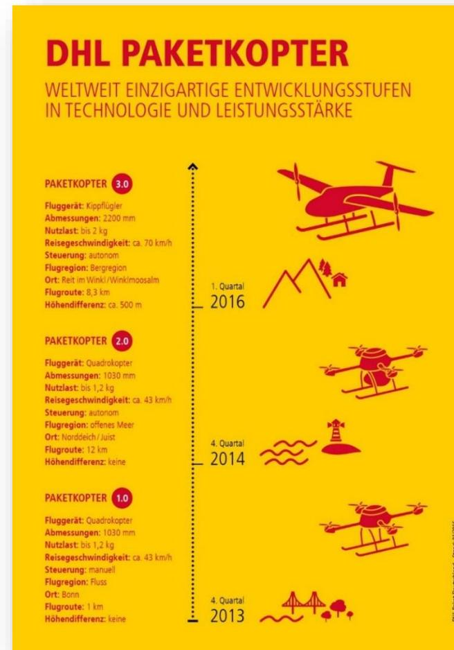
Abbildung 22: Paketkopter Entwicklungsstufen
